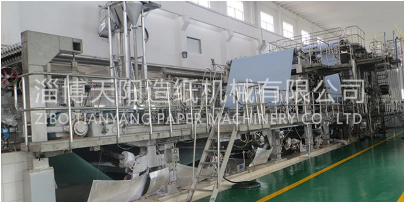
造纸机设备的网部需要保持稳定:造纸机设备的网部是很重要的部分,造纸机网部传动的稳定关系到整条生产线,这个必须要注意。造纸机的网部速度是需要高度频率波动的,这个主要是来自于传动控制系统的编码器与齿轮齿箱间隙,当造纸机的编码器出现问题的时候,反馈速度回有所不准确,这样的话就会产生较大的波动,这个问题是需要注意的。由于造纸机生产问题造成的波动,一般情况下是无法看出来的,就需要在造纸机放料阶段、网上浆层逐渐变厚的过程中才能看得见,在造纸机成纸低速回卷的过程中,才可以看见明暗相间的横印。
